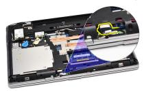
5. Bluetooth カードをシステム基板に固定しているネジを外します。
