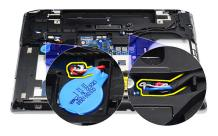
21. LVDS ブラケットを固定している 2 つのネジを外します。
