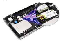
5. モデムをシステムに固定しているネジを外します。
