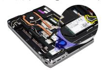
5. WWAN カードをコンピューターに固定しているネジを外します。
