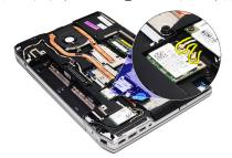
5. WLAN カードをコンピューターに固定しているネジを外します。
