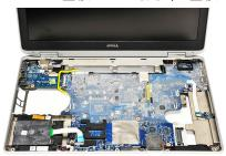
27. システム基板を持ち上げながら、コンピューターから取り出します。
