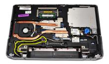
**5.** 電源コネクターブラケットをコンピューターに固定しているネジを 取り外します。
