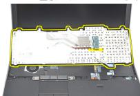
**9.** キーボードケーブルを固定しているテープをキーボードから取り外します。
