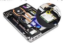
6. WLAN カードをシステム基板上のスロットから取り外します。
