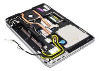
**9.** モデムコネクターブラケットを固定しているネジを外します。
