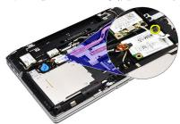
6. モデムカードを持ち上げて、コンピューターから取り外します。
