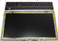
**6.** LVSD (Low-voltage differential signaling) ケーブルコネクターからテープを剥がします。
