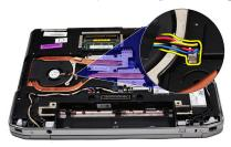
**5.** ヒートシンクアセンブリをシステム基板に固定しているネジを外します。
