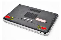
3. バッテリーの外縁部を上方向に回してコンピューターから取り出します。
