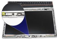
5. ケーブルを接続解除し、カメラモジュールを取り外します。
