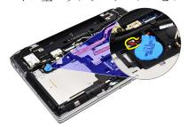
**5.** コイン型バッテリーをコンピューターから取り外します。
