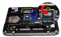
6. プロセッサーを持ち上げてシステム基板から取り外します。
